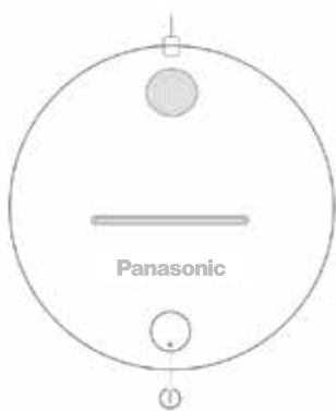
Nút bấm cảm ứng (Chạm để chỉnh màu, giữ lâu để chỉnh sáng)
