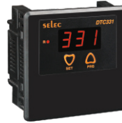
DTC331 96(H) x 96(W) x 38.8(D)mm
